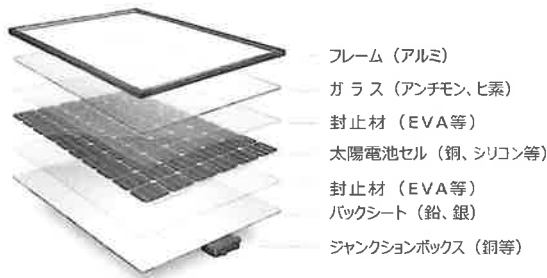
シリコン系太陽電池モジュールの構造（有害・資源性物質）
